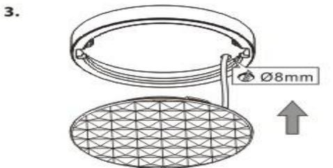
3. Просверлите отверстие для провода (ø8 мм), протяните провод сквозь отверстие и зафиксируйте лампу
