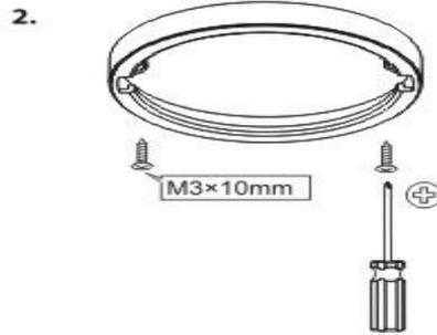
2. Зафиксируйте корпус саморезами
