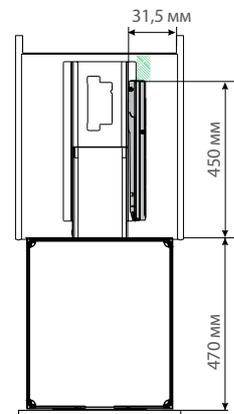
МЕХАНИЗМЫ ДЛЯ КОЛОНОК шириной 450 мм
