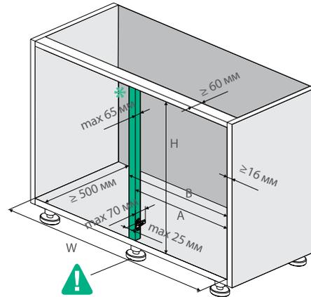
Требуется установка доп. опоры (ножки) согласно схеме монтажа
