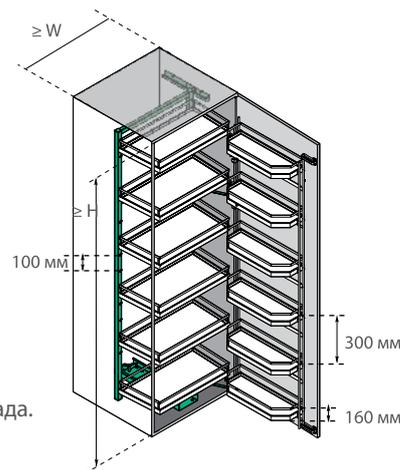
**!** Требуется установка доп. опоры (ножки) согласно схеме монтажа.
