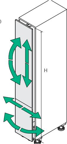
Требуется установка доп. опоры (ножки) согласно схеме монтажа.
