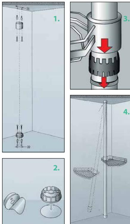
Несущим элементом является труба, которая крепится к полу и потолку, либо к стене или мебели. На трубу надеваются и фиксируются на нужной высоте различные полки и барные столы. Эти элементы могут вращаться вокруг стойки.
