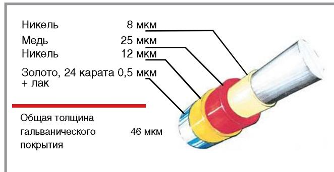
Структура гальванического покрытия труб
