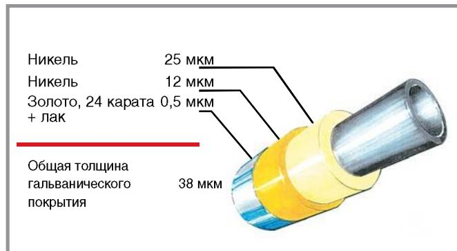
Структура гальванического покрытия проволоки
