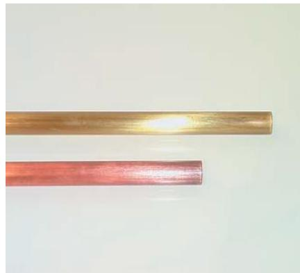
Труба 600 мм, d=16 мм,
