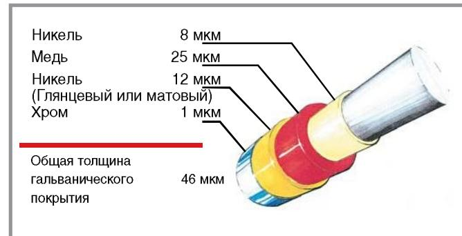
Структура гальванического покрытия труб
